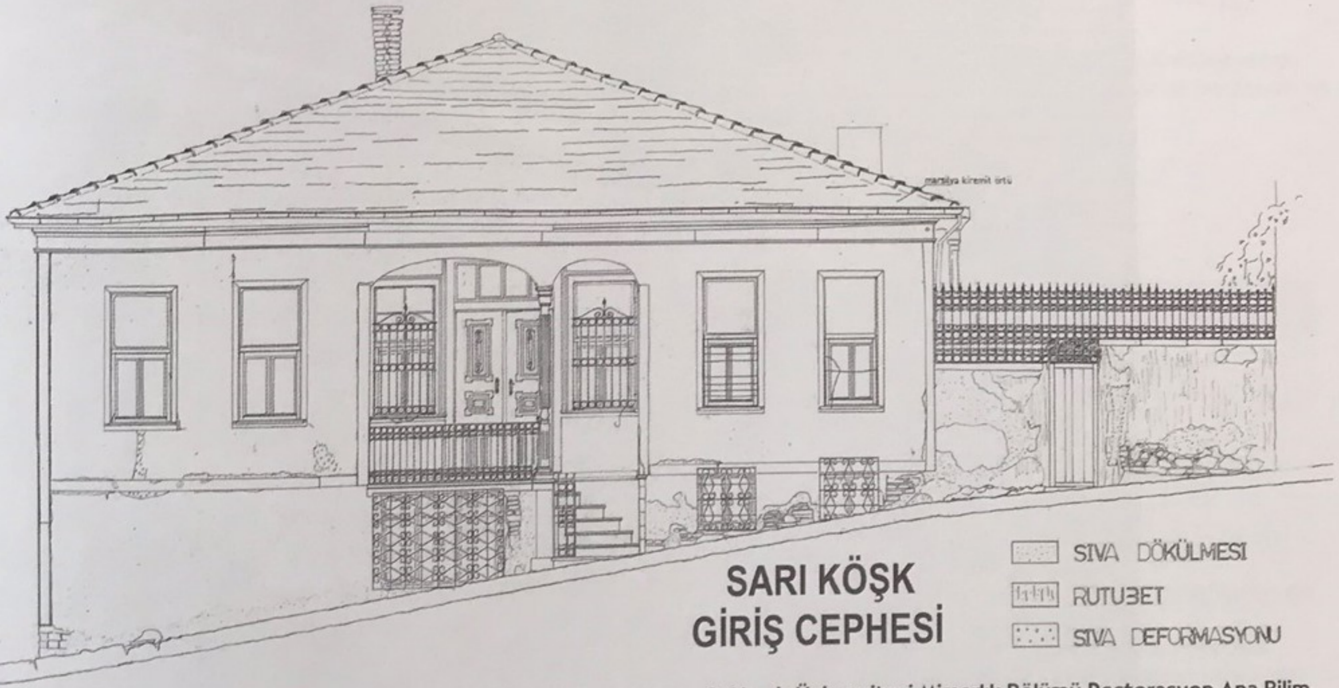
Şekil I. Kâzım Özalp Sokak'ta bulunan ve Sarı Köşk olarak bilinen ahşap yapının Balıkesir Üniversitesi Mimarlık Bölümü Restorasyon Ana Bilim Dalı tarafından gerçekleştirilen röleve projesi.
